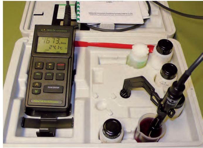
Abb. 6: Krista-Test-Konduktometer zur Bestimmung der Weinsteinsättigungstemperatur
